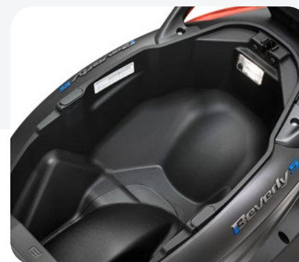
ΑΝΟΙΓΜΑ ΣΕΛΑΣ ΜΕ ΜΗΧΑΝΙΚΟ ΣΥΣΤΗΜΑ ΣΥΓΚΡΑΤΗΣΗΣ ΚΑΙ ΕΣΩΤΕΡΙΚΟΣ ΦΩΤΙΣΜΟΣ
